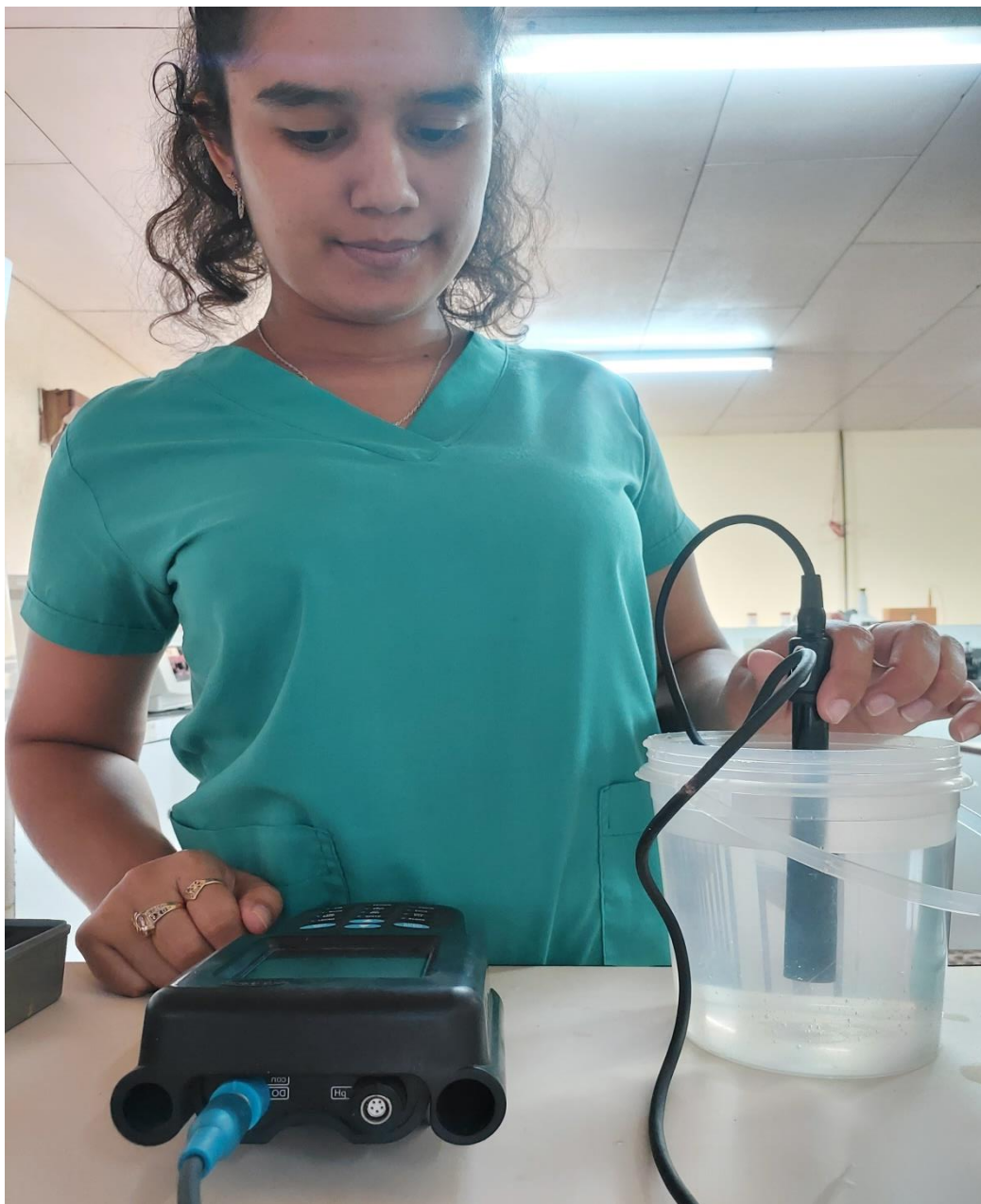
Foto 10. Medición de conductividad eléctrica y PH de las muestras de agua.
