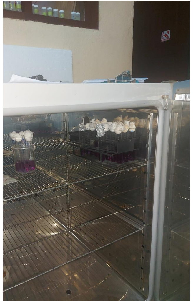
Foto 12 y 13. Procesamiento para el análisis bacteriológico de las muestras de agua en la incubadora.
