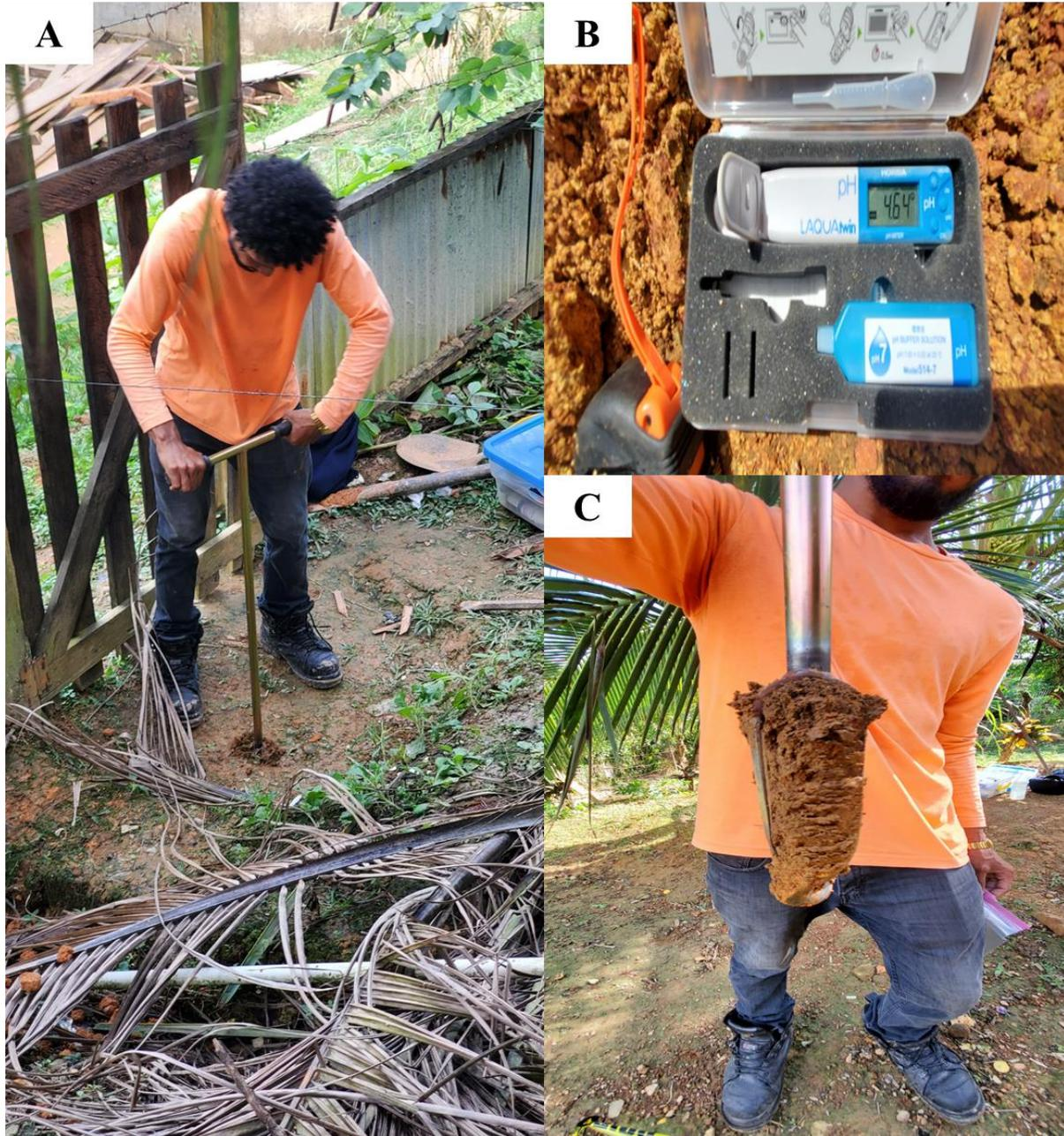
**Anexo 3.** A) Toma de muestra con barreno. B) medición de pH en campo. C) Extracción de muestra de suelo para determinación de textura en laboratorio
