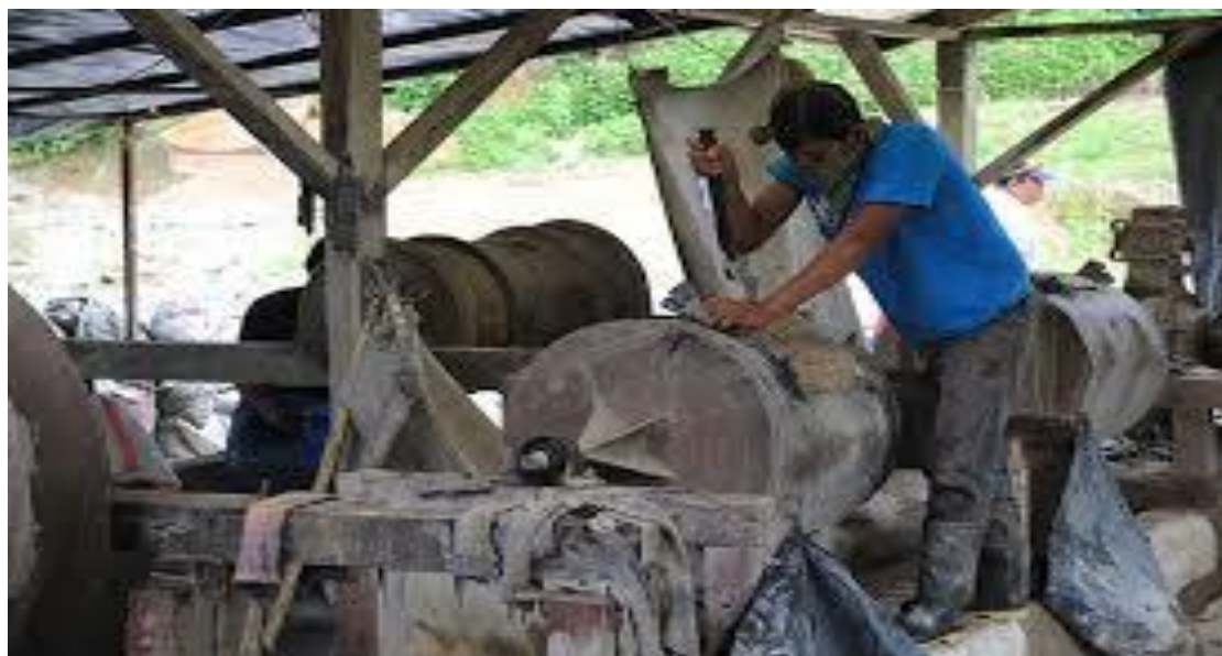
Mantenimiento equipos de trituración
