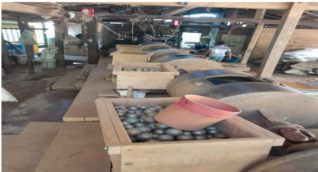
Plantel y 4 molinos para el proceso de trituración de material aurífero
