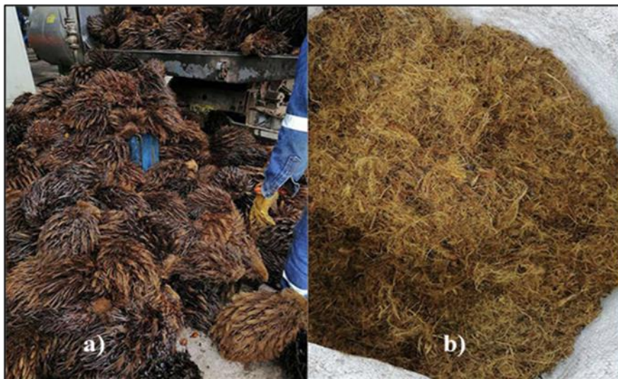
Figura 6. a) Raquis de fruto de palma procesado. b) fibra obtenida del proceso de extracción de aceite.
