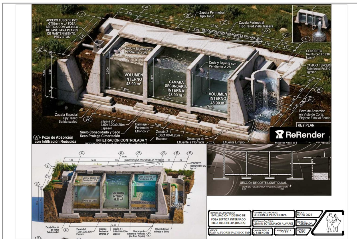
Figura 10. Perspectiva renderizada y sección longitudinal del sistema séptico propuesto en concreto reforzado para el internado de BICU.
